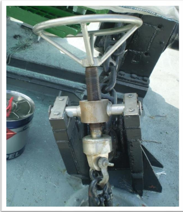
Trincaje anclas y pescante de cerco en Atunero.
