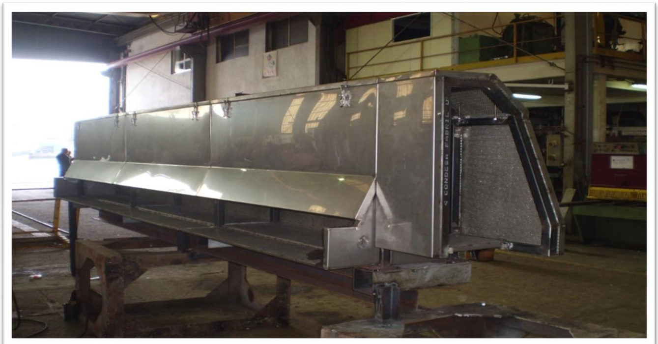
Protección colector escape motor Wartsila en un Atunero
