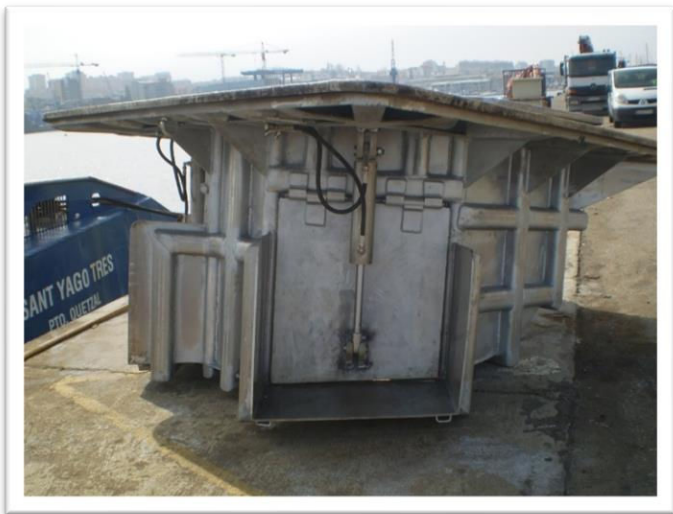
Tolva de 2 bocas hidráulicas para pescado.
