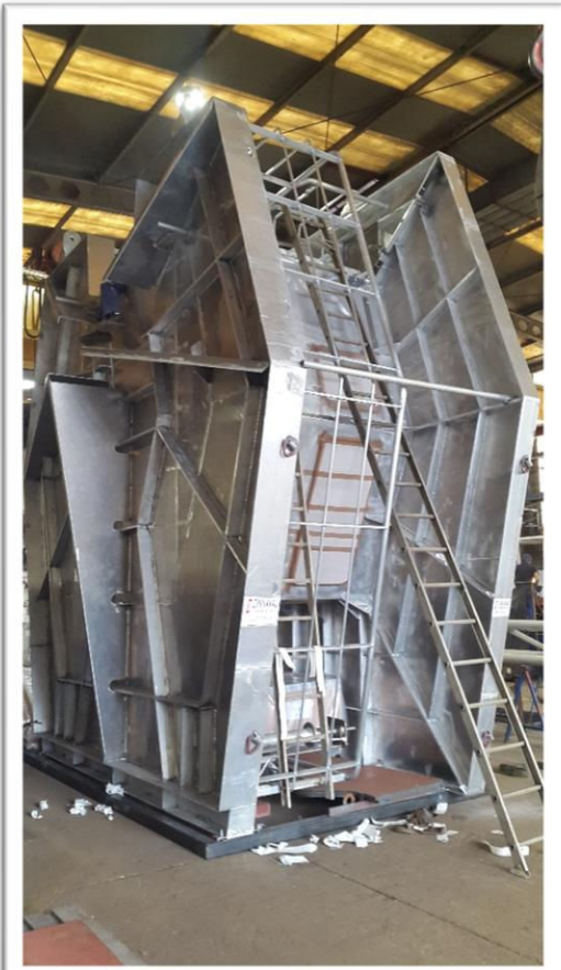
Fabricación de cofa en aluminio.
